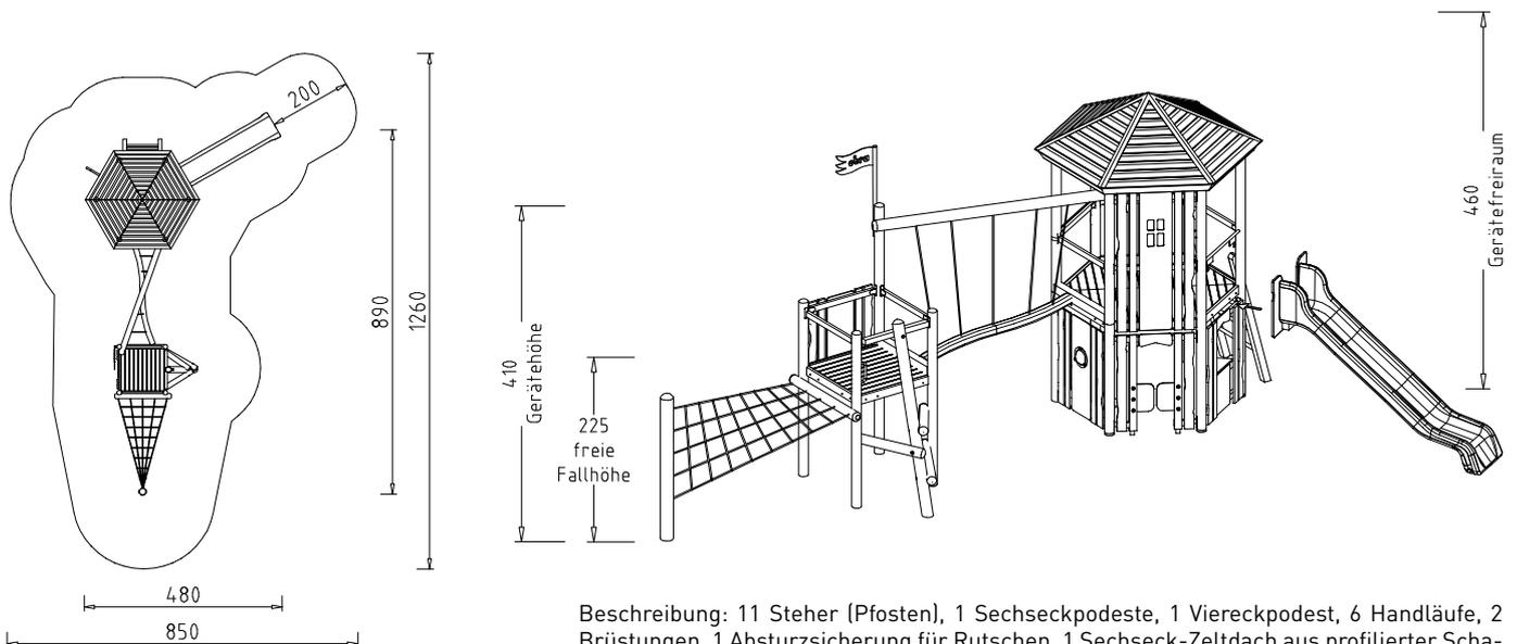
**Beschreibung:** 11 Steher (Pfosten), 1 Sechseckpodest, 1 Viereckpodest, 6 Handläufe, 2 Brüstungen, 1 Absturzsicherung für Rutschen, 1 Sechseck-Zeltdach aus profiliertes Schalung, 1 Leiter, 1 Feuerwehr-Kletterstange, 1 Bergsteiger-Kletterwand, 1 Stangen-Aufstieg, 1 Helix-Netz, 1 Tau-Übergang, 1 Spielwand Tante-Emma-Laden, 1 Spielwand mit Tür, 1 Spielwand hoch mit Sitzbank und Blasenfenster, 1 Fahne aus HPL-Platte, 1 Haltegriff in Edelstahl.
