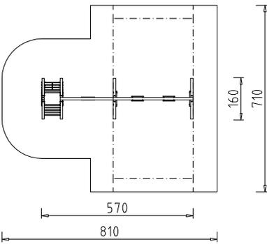
Beschreibung: 2 A-Stützen, 1 Kletterbock Sprossen/Netz, 1 Schaukelbalken, 2 Stabilisierungselemente Stahl/Holz, 2 Sicherheitsschaukeln standard, 1 Strickleiter.
