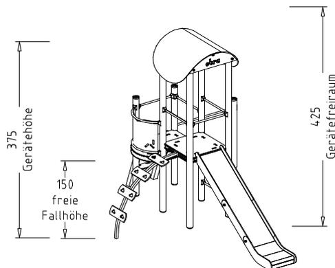
**Beschreibung:** 7 Standpfosten, 2 quadratische Podeste, 1 Kreisbogen-Podest, 1 Brüstung gebogen, 1 Leiter mit Trittstufen aus HPL-Platte mit rutschhemmender Oberfläche, 1 Bogen-Aufstieg aus gebogenem Formrohr, mit Steig- bzw. Halteelementen aus HDPE-Platte 19 mm, 1 Reckstange in Edelstahl, 1 Tonnendach, 1 Rutsche.
