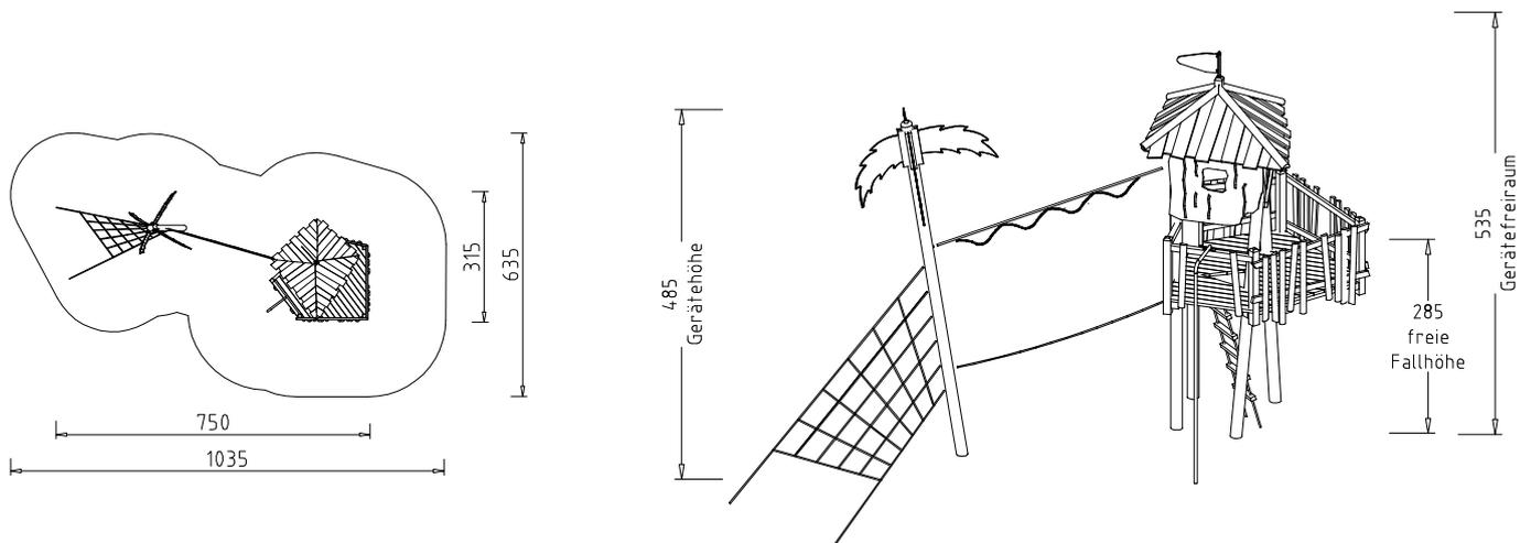
Beschreibung: 1 Steher (Pfosten) Ø 14 cm, 4 Steher Ø 12 cm, Boden mit Podestunterzügen aus Kanthölzern (KH) 9/11 und 9/9 cm, Belag aus Nut-Feder-Brettern 3,5/10 cm, Handläufe aus KH 7/7 cm und 4/7 cm, 4 Brüstungen aus Schichtholzplatte mit Intaglio-Fräisungen, 4 Brüstungen mit Halbhölzern, Dach mit Pfetten und Sparren aus Kanthölzern 9/9 cm, Dachflächen aus Schichtholzplatte mit aufgeschraubten Brettern, mit 1 Wimpel, 1 Strickleiter, 1 Feuerwehrstange aus Edelstahl, 1 Herkules-Seilhandlauf.
