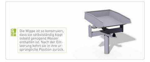
Beschreibung: Wasserbecken aus Niro-Blech 2 mm, V2A, gekantet und geschweißt, vollflächig gebeizt, umlaufende Randeinfassung mit Rundstahl Ø 8 mm, Becken drehbar gelagert (Gleitlager), oberer und unterer Anschlag mit Gummi-Parabelpuffer, 1 Steher (Pfosten) aus V2A Rohr 2" (60,3 mm).
