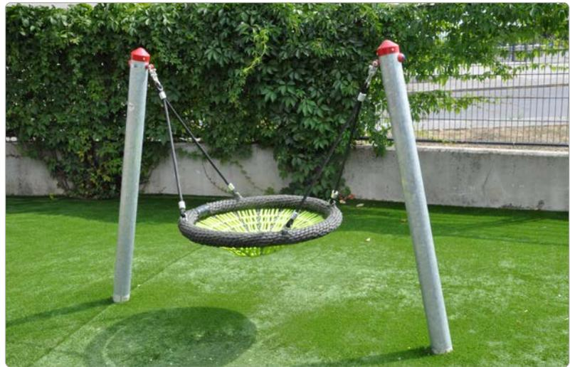
Beschreibung: 2 Rundrohrsteher (-pfosten) Ø 100 mm, feuerverzinkt, mit Abdeckkappen. Blaue Farbe wird beige packt um die Stahlrohre selbst streichen können. Schaukelkorb Ø 90 cm aus Gummigeflecht, mit Stoßdämpfung an den Stahlrohren, inklusive Aufhängerseile (Stahlseil kunststoffummantelt), Original Vogelnest.
