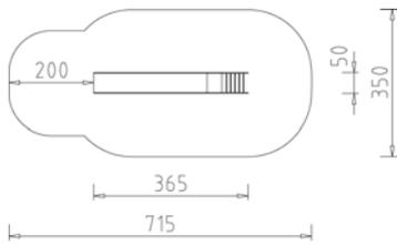
Beschreibung: 1 Aufstiegsleiter mit Handlauf, 1 Rutschwanne mit Einsatzbereich und Auslauf, aus Edelstahl, Werkstoff 1.4301 V2A, Blechstärke 2 mm, geschweißte Ausführung.
