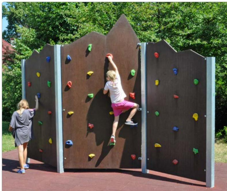
Beschreibung: 4 Stk. Stahl-Formrohrsteher 100/100/4 mm, 3 Stk. Siebdruckplatten 20 mm stark, verschraubt an Befestigungsglaschen, Klettergriffe in verschiedenen Größen und Farben, Klettergriffe beidseitig, durchgeschraubt.
