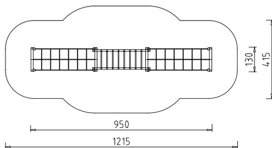
**Beschreibung:** 8 Steher (Pfosten) aus Rundhölzern Ø 14 cm, 1 Hängelleiter, 2 Schlauffenetze aus Herkulestau Ø 22 mm, Farbe rot, mit Endenpressungen und Gewindestiften, zum Durchschrauben.
