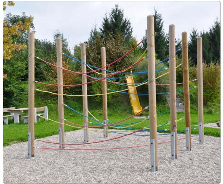
**Beschreibung:** 8 Steher (Pfosten) aus Rundhölzern Ø 16 cm, Balancier- und Haltetaue Ø 22 mm, in unterschiedlichen Farben, mit Endenpressungen und Gewindestiften, zum Durchschrauben, die Rundholzsteher aufgeständert mit Vierfachlaschen.
