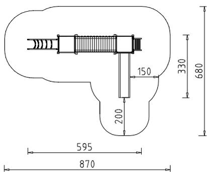
Beschreibung: 8 Steher (Pfosten), 2 Podeste, 3 Handläufe, 10 Brüstungen mit Intaglio-Fräsungen, 1 Absturzsicherung für Rutsche, 1 Fixbrücke, einseitig mit Brückenbogen, einseitig mit senkr. Brüstungsverkleidung, 1 Aufstiegsleiter, 1 Mondleiter.
