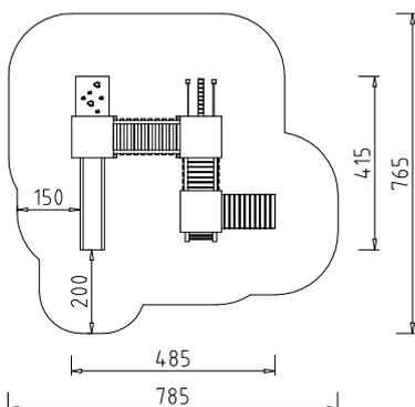
Beschreibung: 14 Steher (Pfosten), 3 Podeste, 5 Handläufe, 3 Brüstungselemente, 1 Fixbrücke schräg, 1 Verbindungsrampe schräg mit Brüstungsverkleidung senkrecht, 1 Leiter, 1 Rampe, 1 Stufenbaum, 1 Bergsteiger Kletterwand.
